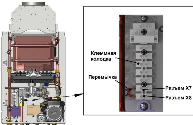
*Подключение соединительного кабеля к котлу*
